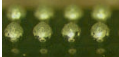
그림 11: Type V 솔더 페이스트 디핑 후의 상단 패키지 볼
