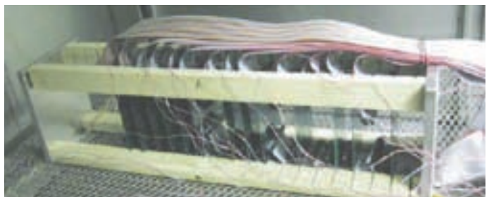
그림 16: ATC칩임버 내의PoP 테스트 장비 랙
