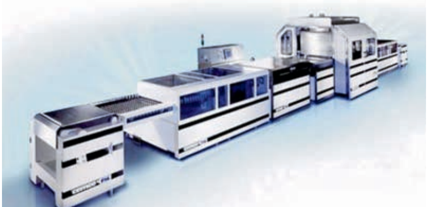
그림 5: 침단 자동화 인라인 수평 HASL 라인(사진 출처: Cemco/FSL Ltd)
