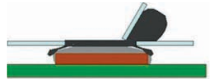
그림 4: 비공면 HASL 도금의 스텐실 gasketing 문제에 의한 페이스트 블리드
